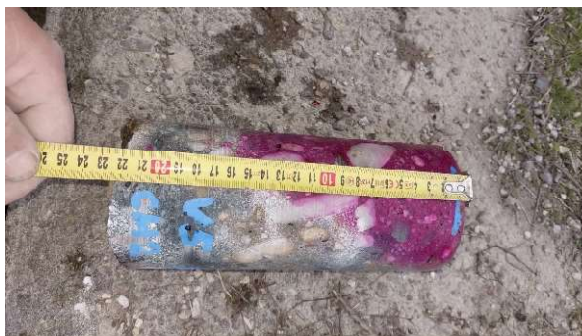
Obr. 10 Nástrek roztoku fenolftaleínu na odobratom vývrte z konštrukcie
