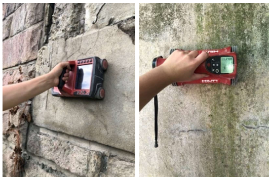
Obr. 12 Nedeštruktívne určovanie parametrov výstuže
