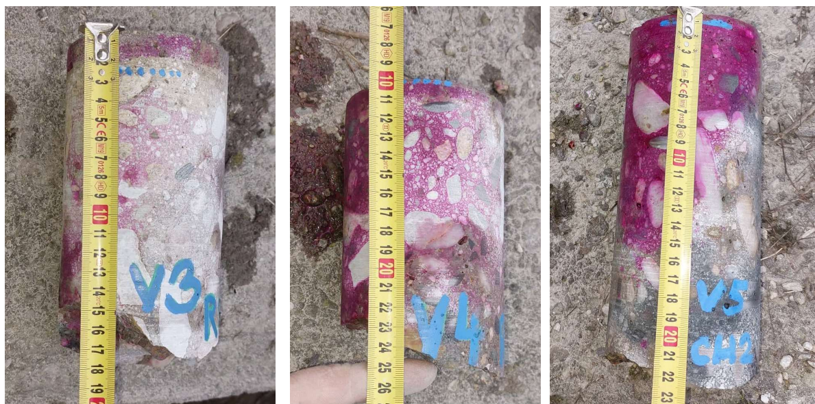
Obr. 17 Ukážka odobratých vrtov z opôr spodnej stavby mostného objektu
