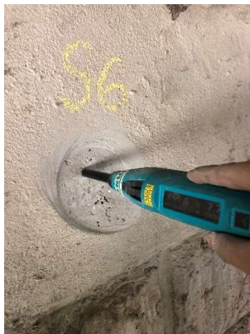
Obr. 9 Meranie Schmidtovým tvrdomerom
