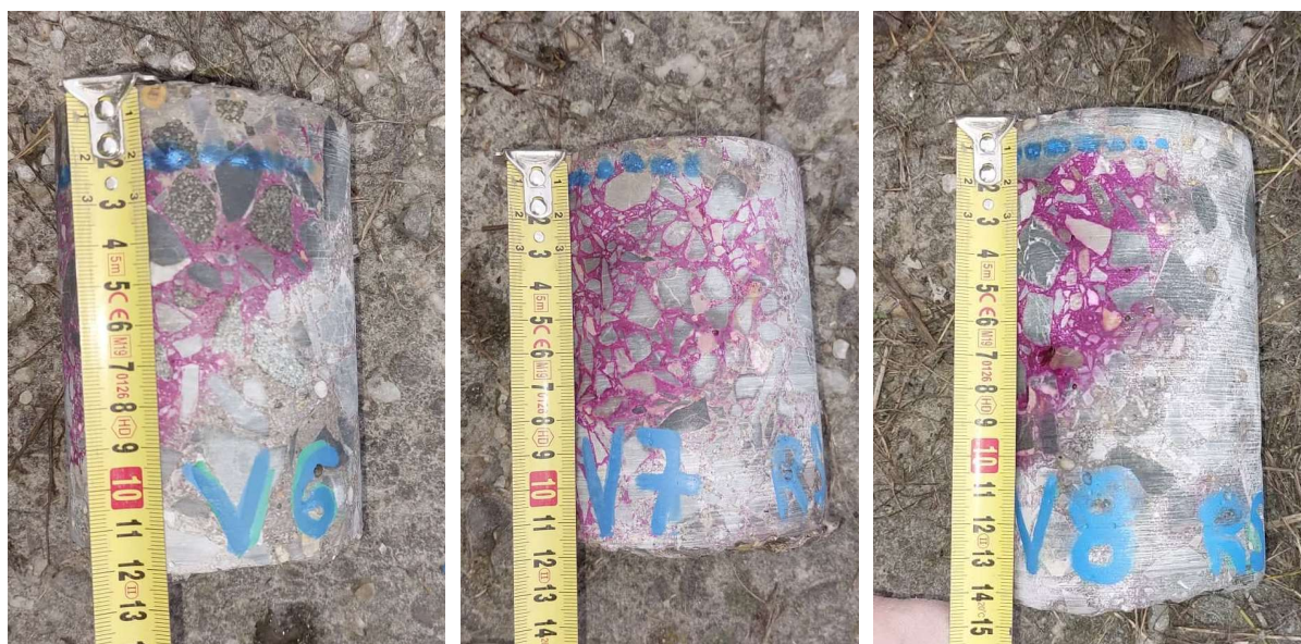
Obr. 16 Ukážka odobratých vrtov z nosníkov mostného objektu
