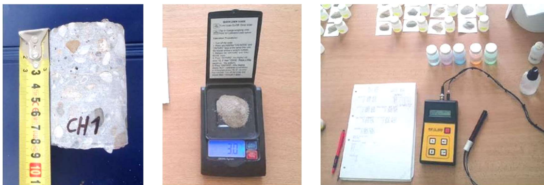
Obr. 11 Odobratá vzorka (vľavo), váženie namletej vzorky (stred) a meranie obsahu chloridových iónov (vpravo)
